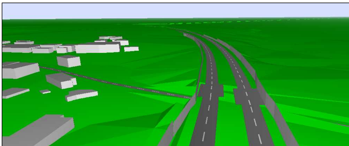
Figura 4-7 – Barreiras acústicas junto à A3.
