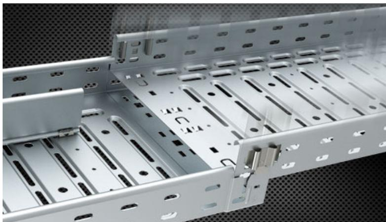
Os caminhos de cabos metálicos, são construídos em chapa de aço macio, perfurada e estampada, galvanizada a quente em banda contínua antes da maquinação conforme a norma EN 10346.
